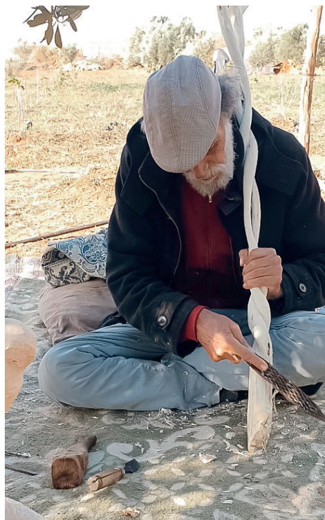
M'hammed El Aadi travaille sur du bois d'olivier par l'utilisation du maillet, burin et de la râpe à bois, à Boulâaouane, Prises par Laila Sidqui, 16 décembre 2023
